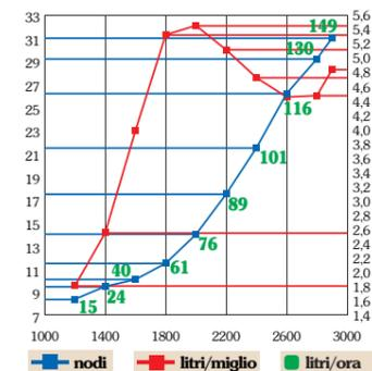
I consumi indicati nel grafico sono stati forniti direttamente dal cantiere sulla base delle prove effettuate in mare. I consumi potranno discostarsi dai dati pubblicati in funzione del carico imbarcato e della sua posizione, delle condizioni di uso dell'unità, della messa a punto e dello stato dei motori stessi, oltre che dalle caratteristiche delle eliche utilizzate.
