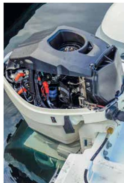
burante iniettato direttamente nella camera di combustione. L'iniezione diretta E-TEC di BRP, rispetto a tecnologie precedenti, offre una notevole efficienza finalizzata altresì alla riduzione dei consumi. L'obiettivo da raggiungere era quello di combinare la potenza e la brillantezza dei motori fuoribordo a due tempi con le caratteristiche di pulizia e silenziosità dei motori a quattro tempi.
