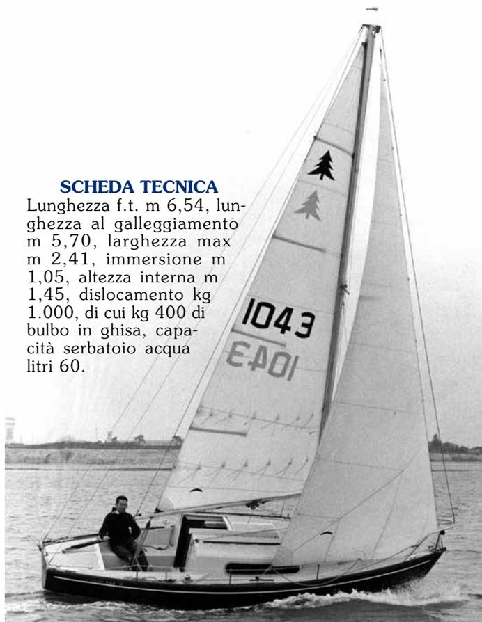
**Cosa appare datato:** la carena a sezioni trasversali piuttosto tondeggianti, lo skeg, il trasto di randa che taglia in due il pozzetto.
