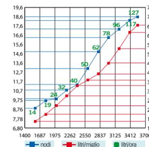
I consumi indicati nel grafico sono ricavati dalle curve di consumo del motore fornite dal costruttore, ma il consumo reale in mare potrà discostarsi dai dati pubblicati in funzione del carico imbarcato e della sua posizione, delle condizioni di uso dell'unità, della messa a punto e dello stato dei motori stessi, oltre che dalle caratteristiche delle eliche utilizzate.
