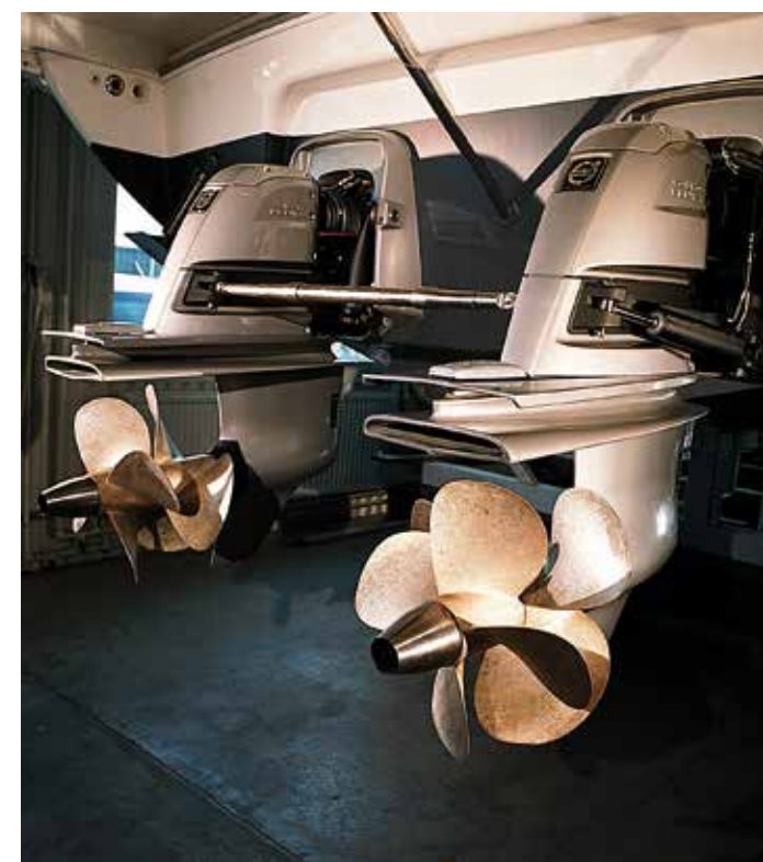
Ecco come appare oggi un moderno DuoProp in installazione singola e in installazione binata.
