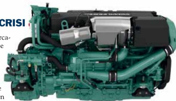
applicata al settore marine. L'architettura sei cilindri non è cambiata e invariata è anche la cubatura da 10,84 litri con relativi cinematismi interni, ma il monoblocco è stato rivisto nella struttura al fine di offrire livelli di resistenza più elevati, obiettivo raggiunto grazie a un largo utilizzo della modellizzazione
