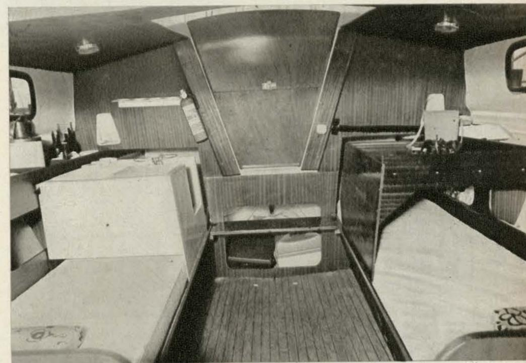
*In alto: l'entrata in cabina con parte del pozzetto; in primo piano la barra di scotta della randa con trasto mobile. A destra: la zona poppiere della cabina centrale; ai due lati, sopra le cuccette, sono sistemati il blocco cucina ed il tavolo da carteggio estraibili. Sotto: ecco come appare l'interno della cabina con la tenda chiusa.*
