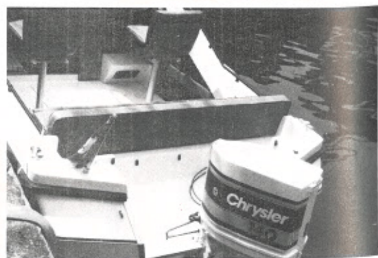
In alto: la filante sagoma del Rio 580 Cabin lanciato in velocità; da notare l'ottimo assetto. A fianco: una vista d'insieme di questo semicabinato, qui nella versione fuoribordo. Sotto: a sinistra, particolare del posto di pilotaggio; a destra, l'estrema zona poppiera, in cui è ricavato il pozzetto del motore fuoribordo, per l'occasione un Chrysler da 140 HP.
