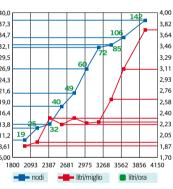
I consumi indicati nel grafico sono ricavati dalle curve di consumo del motore fornite dal costruttore, ma il consumo reale in mare potrà discostarsi dai dati pubblicati in funzione del carico imbarcato e della sua posizione, delle condizioni di uso dell'unità, della messa a punto e dello stato dei motori stessi, oltre che dalle caratteristiche delle eliche utilizzate. minimi di planata: 2.000 giri/min, 10,1 nodi - Velocità massima: nodi 38,2.
