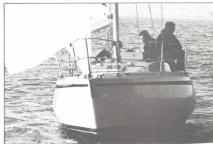
Sopra: lo specchio di poppa del First 30; da notare l'uscita decisa. Sotto: l'immagine mette bene in evidenza la classica prua di Mauric, poco immersa. A destra: la sentina ed i madieri nella zona del bulbo; come si vede, in questa parte lo scafo è controstampato.
