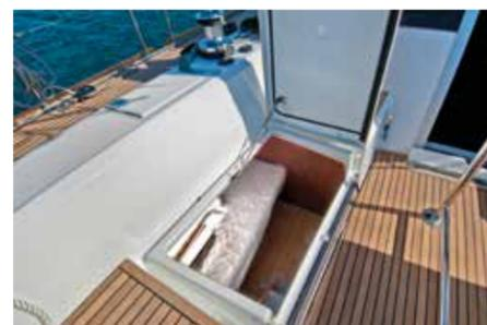
piacevoli da vivere - Gavone ancora: ampio e profondo, con accesso da cala vele dotata di scaletta - Bitte e passacavi: 4 per lato, di buona dimensione con listelli passacavi
