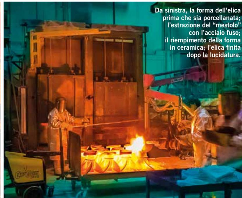
Da sinistra, la forma dell'elica prima che sia porcellanata; l'estrazione del "mestolo" con l'acciaio fuso; il riempimento della forma in ceramica; l'elica finita dopo la lucidatura.
