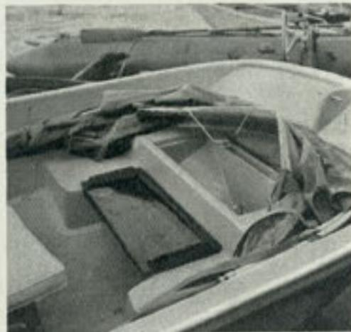
In tutti e due i Boston Whalers provati, vi è a prua un vivale per pesci con coperchio e foro di scarico. Si può anche notare la sistemazione della cappottina.
