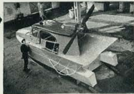
Nell'unione Sovietica è stato costruito questo originale veicolo ad elica aerea, dotato inferiormente di pattini, per i trasferimenti veloci sui fiumi o sui laghi ghiacciati.
